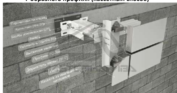
Вертикальная система крепления на основе Т-образного профиля (кассетный способ)
