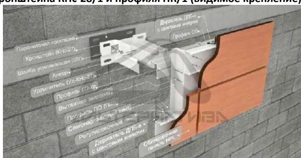
Система крепления в межэтажные перекрытия на основе кронштейна КНС-28/1 и профиля ПК/1 (видимое крепление)
