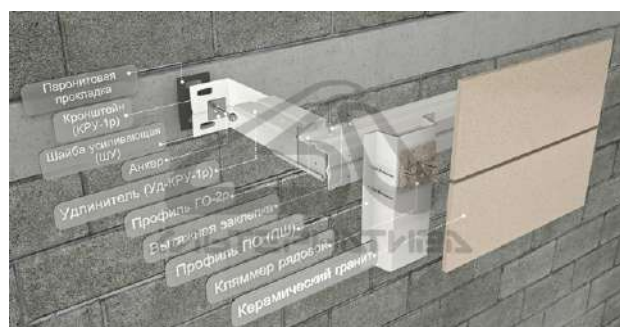
Система крепления в межэтажные перекрытия на основе кронштейна КРУ-1р
