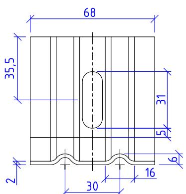
Сталь 08пс, 12Х18Н10Т (AISI 321), 08Х18Н10Т (AISI 304), 12Х17 (AISI 430)
