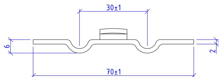
Сталь 08пс, 12Х18Н10Т (AISI 321), 08Х18Н10Т (AISI 304), 12Х17 (AISI 430)
