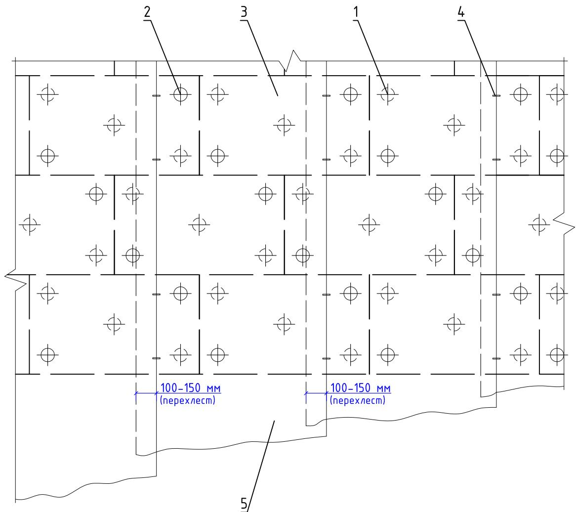
1. Тарельчатый дюбель установленный под ветро-гидрозащитной паропроницаемой мемброй
