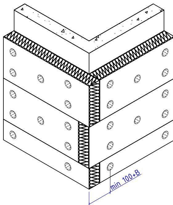
1. Крепление теплоизоляционных плит к стене осуществляется тарельчатыми дюбелями из расчета:
