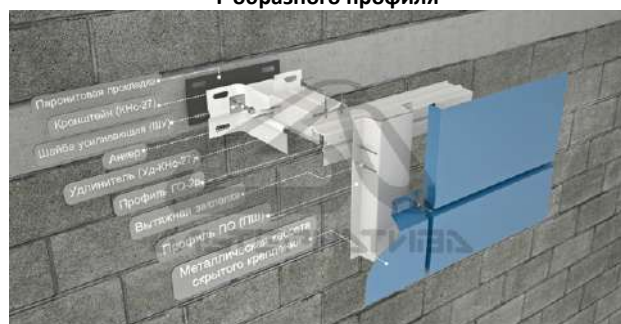
Вертикальная система крепления на основе Т-образного профиля
