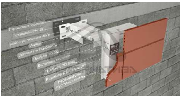
Система крепления в межэтажные перекрытия на основе кронштейна КНс-27 с применением кляммера КТ-К для плит Agrob Buchtal
