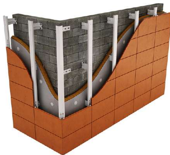
Вертикальная система крепления на основе С-образного профиля
